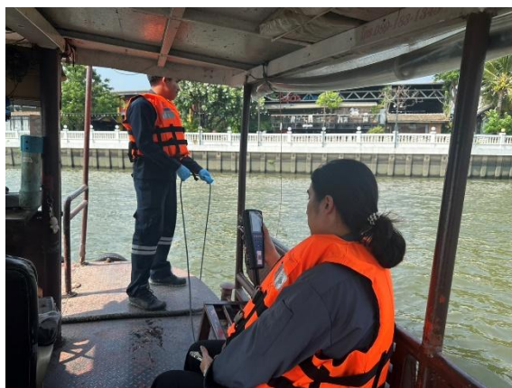
การตรวจวัดการแพร่กระจายอุณหภูมิน้ำหล่อเย็น (เมื่อวันที่ 9 เมษายน 2568)
