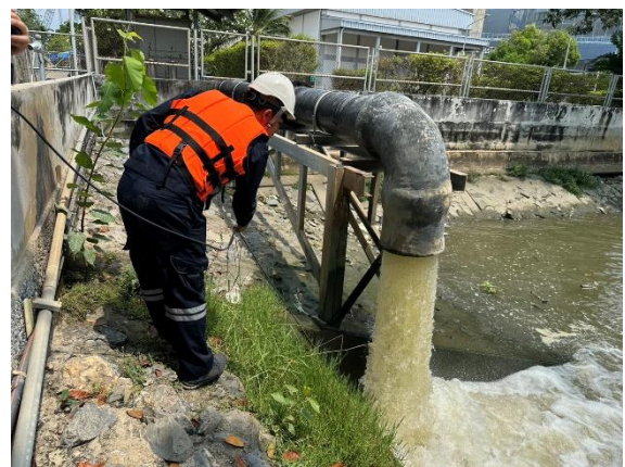
การตรวจวัดการแพร่กระจายอุณหภูมิน้ำหล่อเย็น (เมื่อวันที่ 9 เมษายน 2568)
